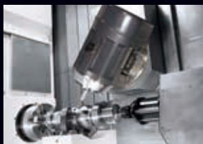
Fraisage/Tournage par axe B outil en broche
