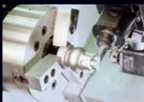
Broche avec entraînement par courroie disponible avec axe C
