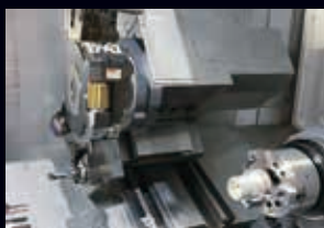
Moteur Broche disponible avec axes C/Y et broche secondaire
